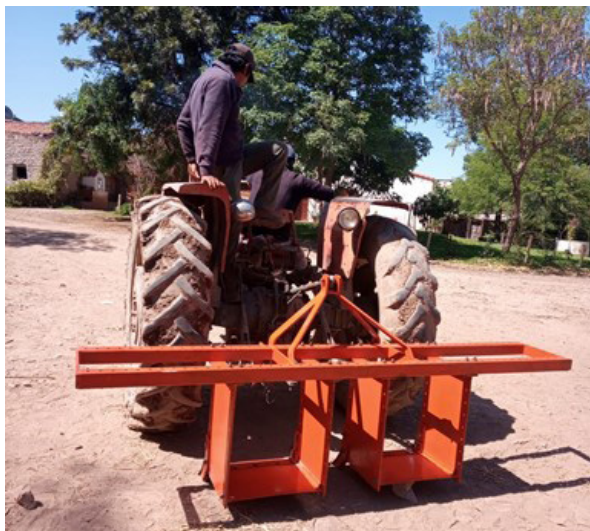
Figura 5: Máquina arrancadora de cebolla, montada en un tractor a con sistema de enganche de 3 puntos.
